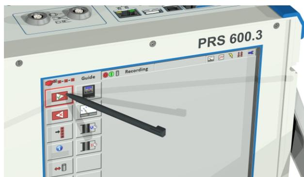
En outre, le système peut également être commandé confortablement à l'aide d'un clavier ou d'une souris connecté au connecteur USB de type A du PRS 600.3. Ceci est particulièrement utile si le système est utilisé en laboratoire.
